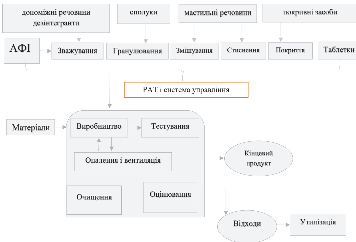
Рис. 3. Процес виготовлення твердих лікарських засобів шляхом технології безперервного виробництва Джерело: складено авторами
